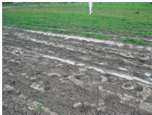
图 9.典型的黑棉土开裂和雨后地表渍水
